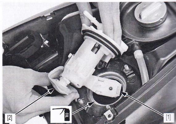
Die Kraftstoffpumpeneinheit [1] wie gezeigt um 90 Grad drehen.
