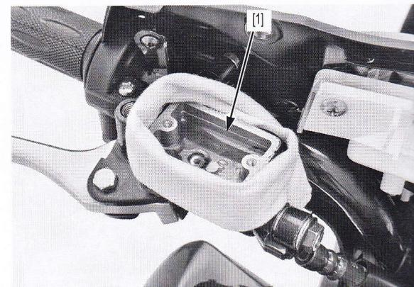
Membran [1], Membrandeckel [2] und Behälterdeckel [3] einbauen und die Schrauben [4] auf das vorgeschriebene Anzugsdrehmoment anziehen.
