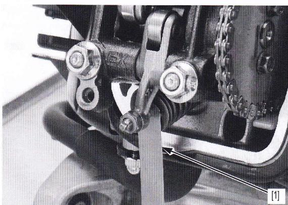
Wenn das Ventilspiel nicht stimmt, zum Einstellen des Ventilspiels die Kontermutter [1] der Ventileinstellschraube lösen und die Einstellschraube [2] drehen, bis an der Fühlerlehre leichter Widerstand fühlbar ist.
