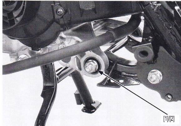
Den Stoßdämpfer [1] so ansetzen, dass die Schraubenbohrungen fluchten.
