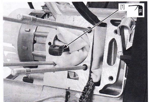
Motoröl auf die Gleitfläche des Kolbens [1] und innen in die Kolbenbolzenbohrung [2] geben.
