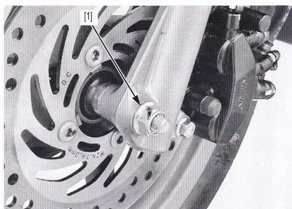
Den Geschwindigkeitsmesserantrieb [1] von der rechten Radnabe bauen.
