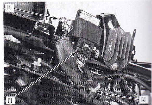
Die Kraftstoffpumpenkabelclips [1] einbauen.
