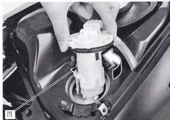
Die Unterseite der Kraftstoffpumpeneinheit [1] näher an die Kante des Kraftstofftanklochs [2] bringen.
