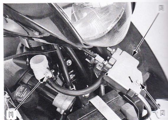
Den Hinterradbremsszug 2 [1] vom Bremsausgleicher [2] und vom CBS-Hauptbremszylindergehäuse trennen.
