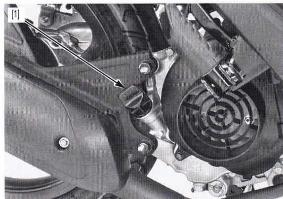
Den Öleinfüllverschluss mit Peilstab [1] einsetzen – nicht einschrauben –, entnehmen und den Ölstand prüfen.
